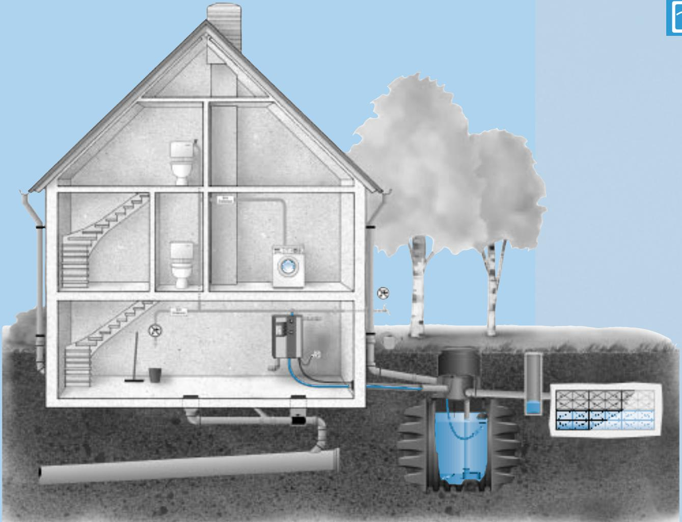
**IWM®-Intelligentes Wasser-Management:** Hier wird der **IRM®** Regenmanager RME, kombiniert mit dem **IRM®**-PE-Filtertank, gemeinsam mit dem Versickerungssystem Eco-Cube eingesetzt. Dies ermöglicht eine optimale Trinkwassersparnis und Regenwassernutzung.
