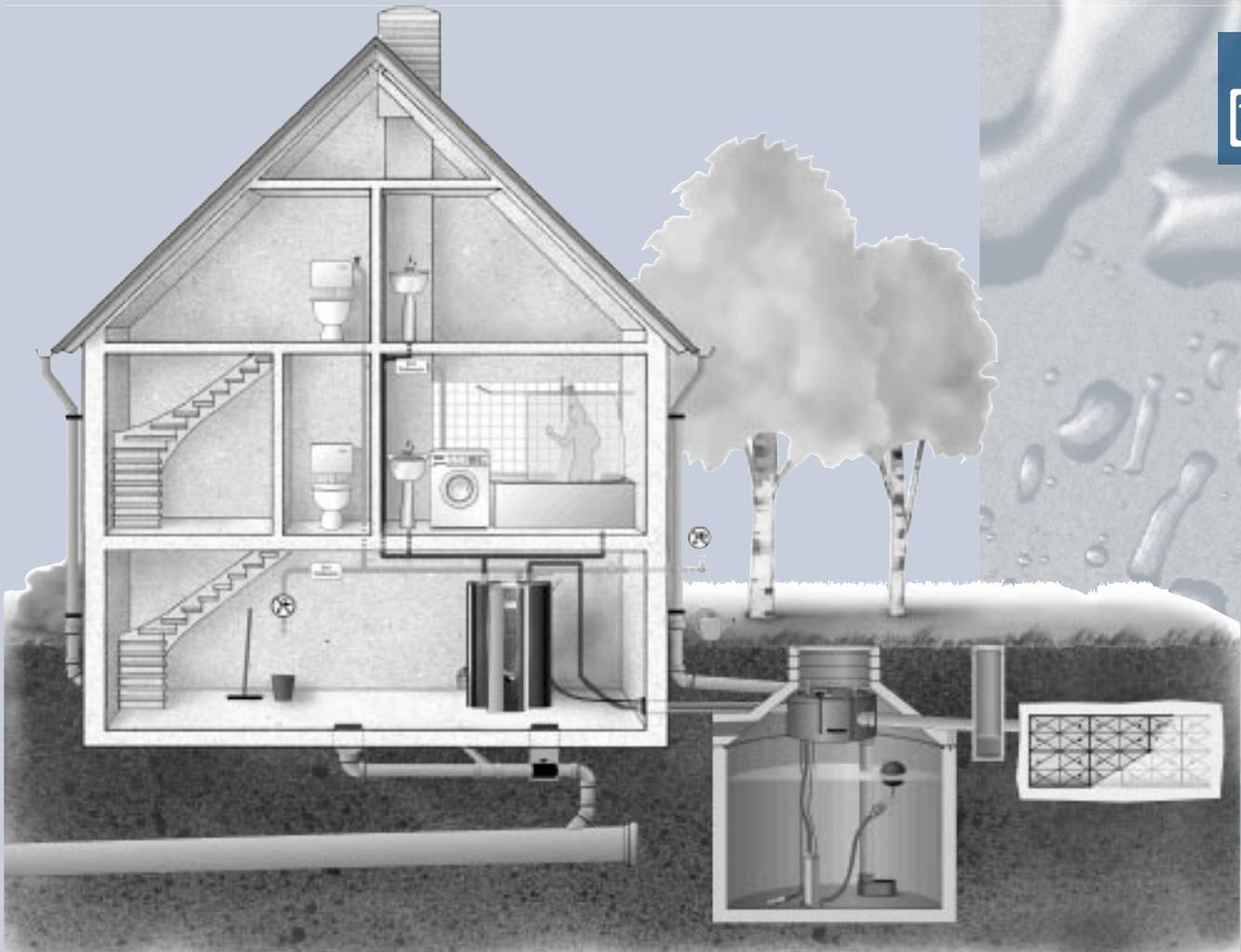
**IWM®-Intelligentes Wasser-Management:** Die IWM®-Grauwasser-Recyclinganlage wird ideal mit einem Regenspeicher ergänzt und ggf. mit einer Versickerung für das überschüssige Regenwasser kombiniert.
