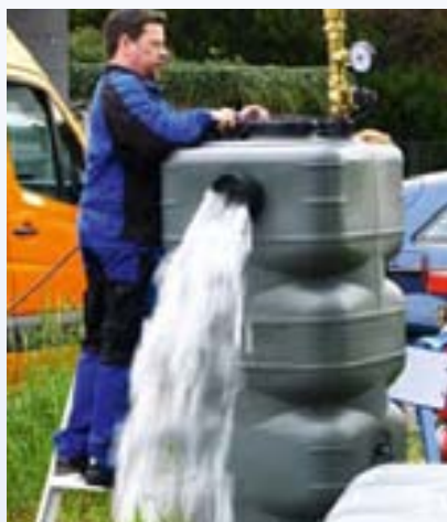
▲ Belastungstests: sichere Abführung des Betriebswassers im Fall der Fälle
