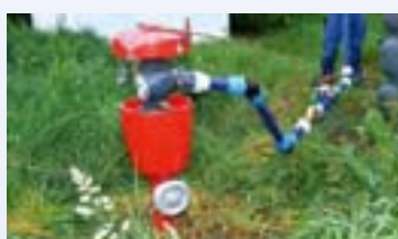
▲ Belastungstests: sichere Abführung des Betriebswassers im Fall der Fälle
