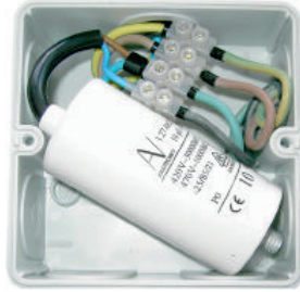
Bild 7: Verteilerdose mit angeklebtem Kondensator
